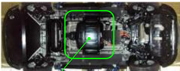
배터리 시스템 장착 위치 : 차량 하부 (중앙)
